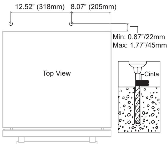
3. (A) Luego inserte el perno de expansión en el orificio perforado. Asegúrese de que quede al ras del suelo. (B) Desenrosque la tuerca, la arandela y el anillo de bloqueo del tornillo.
