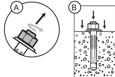
4. Luego, alinee el orificio del soporte con el tornillo y vuelva a colocar la arandela y el anillo de bloqueo en su lugar. Finalmente, apriete la tuerca con una llave o casquillo tanto como sea posible. A medida que apriete el protector, se doblará hacia afuera, creando un anclaje que brinda seguridad adicional a su unidad.
