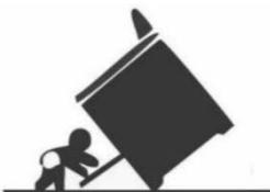
La cocina debe asegurarse con un dispositivo antivuelco correctamente instalado para reducir el riesgo de vuelco. Consulte las instrucciones de instalación que vienen con el documento adjunto para más detalles antes de comenzar la instalación
